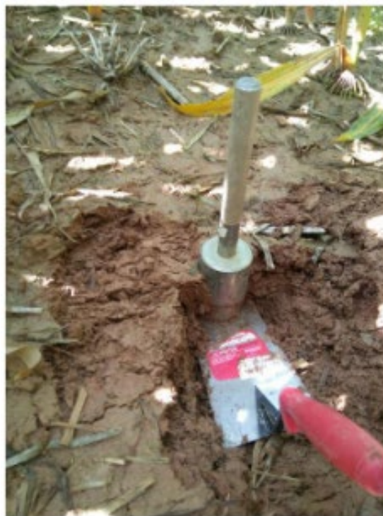
Imagen 8: Realización del muestro de suelo para determinar la densidad aparente mediante el método del cilindro.
